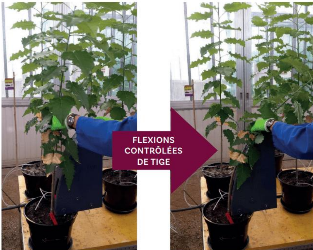
Figure n° 1 : Flexions répétées de tiges de jeunes peupliers en serre simulant l'impact mécanique du vent. L'intensité des flexions est contrôlée par l'utilisation de gabarits spécifiques © B. Niez
